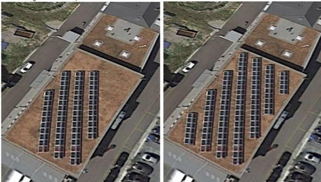
Bestehende PV-Anlage: 30.21 kWp (Bildquelle: Google Earth Pro) Photomontage Erweiterung 2020: 48.69 kWp
